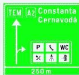
Presemnalizare pe autostradă pentru spațiu de servicii
