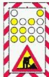
Semnalizarea unui utilaj care se deplasează lucrând
