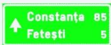
Confirmarea direcției de mers pe autostradă spre localități mai importante și distanțele până la acestea
