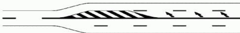
Marcaj la îngustarea drumului cu o bandă pe sens
