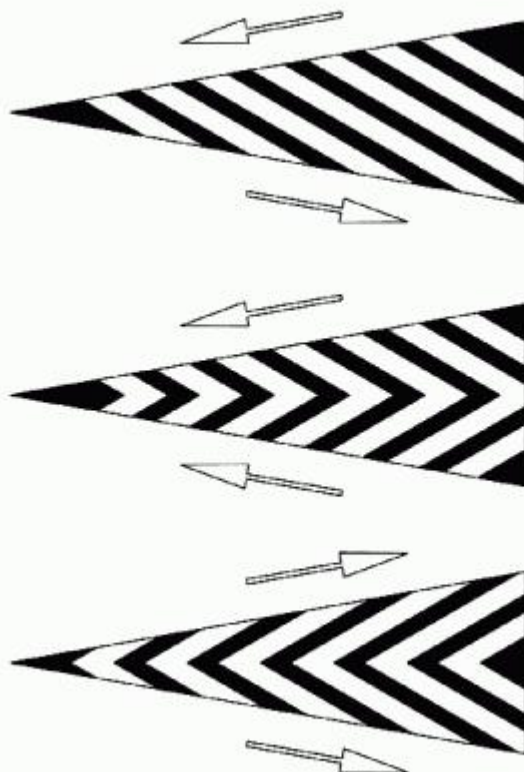
Spații interzise circulației
