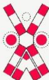
Trecere la nivel cu o cale ferată dublă, fără bariere, prevăzută cu semnale luminoase de avertizare a apropierii trenului
